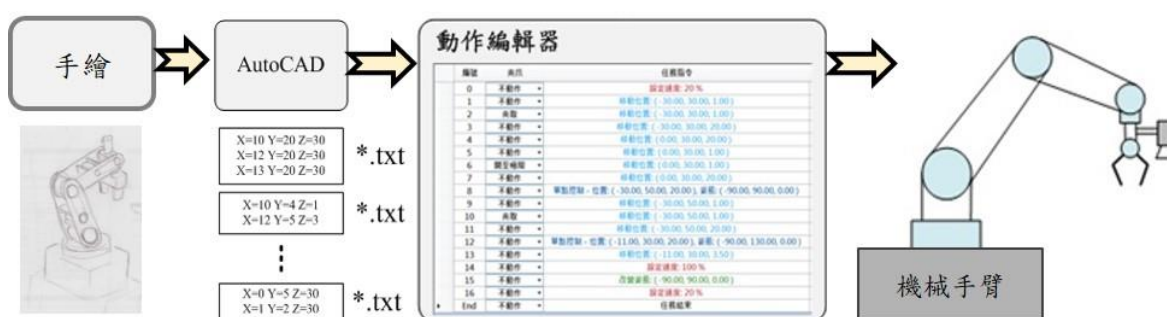
圖 1.5、傳統之機械手臂繪圖系統的處理流程
