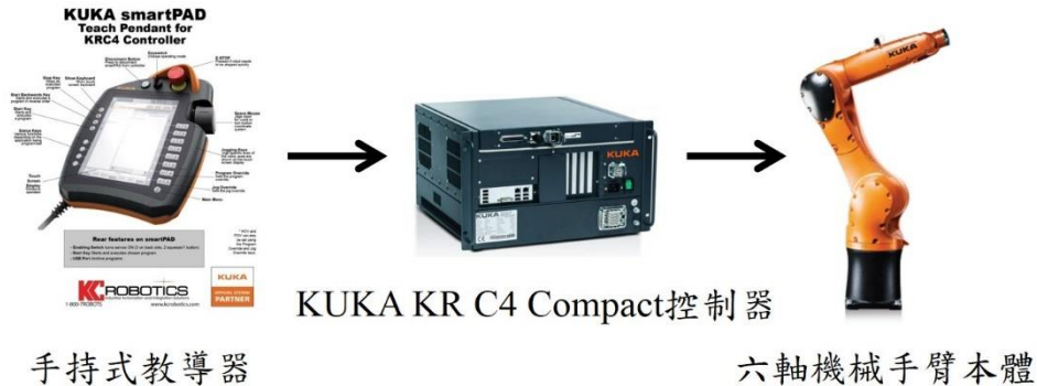
圖 2.1、KUKA KR6 R900 機械手臂的系統架構圖
